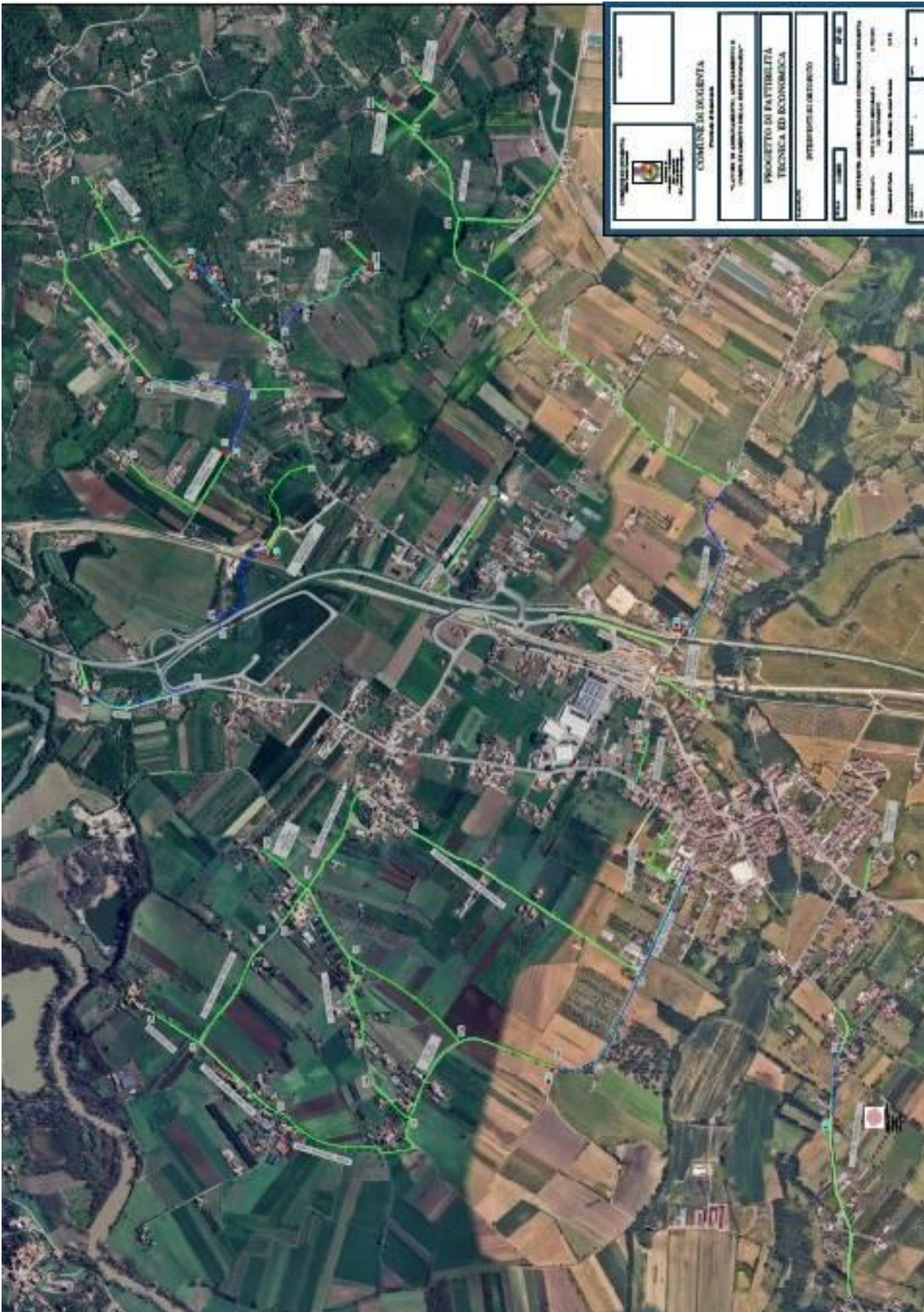
Fig. 1. Le aree interessate dal progetto: condotta a gravità (in verde), condotta premente (in blu), impianti di sollevamento (in rosso).
